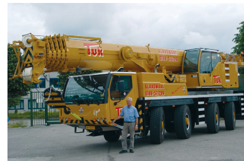
▷ Herman Tuk en zijn nieuwe LTM1090-4.1 met daarop 2,6 ton extra ballast, afgelegd voor de kraancabine.
