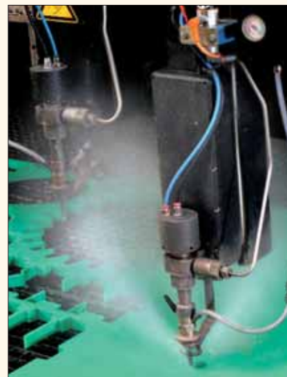
De waterstraalsnijmachine is voorzien van een dubbele kop om sneller te kunnen produceren en om machinestilstand wegens reparatie of onderhoud tot het uiterste te beperken. Ook de dubbele pomp dient deze twee doelen. Een eigen diamantnozzle verlengt de standtijd en verhoogt daarmee eveneens de beschikbare machinetijd.
